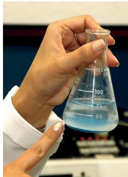
Solução aquosa de nitrato de cobre em contato com a quitosana. A coloração azulada demonstra a adsorção de cobre no pó da quitosana
