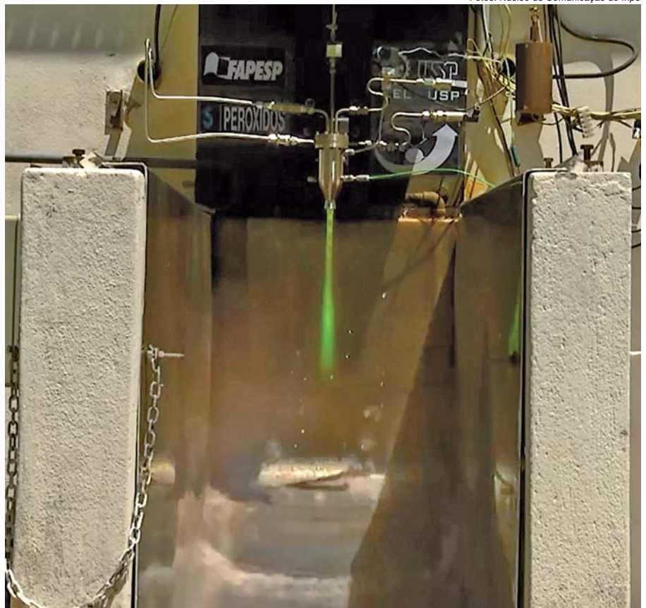
Teste do motor funcionando com o novo combustível, que usa nitrato de cobre como catalisador da reação
