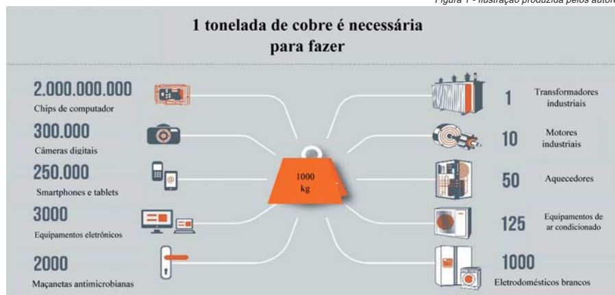
Exemplos de aplicações do cobre e o consumo estimado (adaptado do European Copper Institute)
